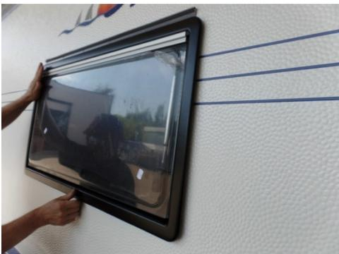
Das Fenster (Außenteil) in den Ausschnitt einsetzen.
