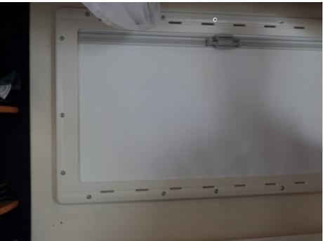
Den Innenrahmen mit dem mitgelieferten Montagematerial mit dem Außenteil verschrauben und die Schraublöcher mit den Abdeckkappen verschließen.
