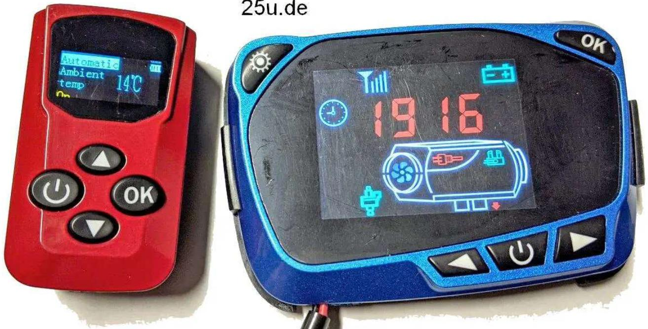
Die blaue Steuerung, mit bidirektionalem Funkteil und roter Fernbedienung. Die Funkbedienung gibt es mit rotem und schwarzem Gehäuse.
