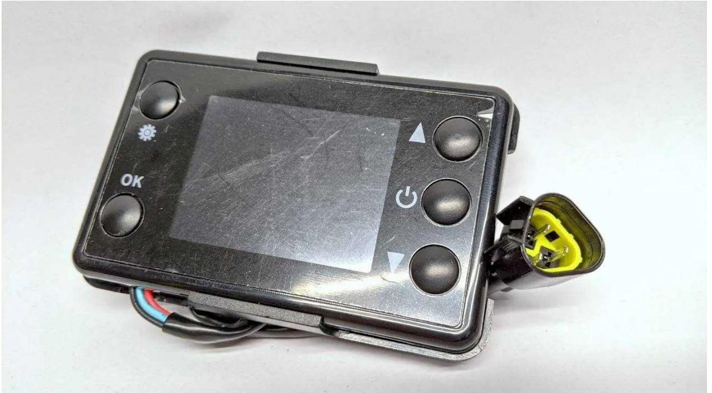
Die „Standard Steuerung“ mit einem einfachen LCD Display. Das Display passt zur 12 Volt und zur 24 Volt Variante. Die Betriebsspannung kann im Service Menü umgeschaltet werden. Lange Zeit war das das einzige Bedienteil, inzwischen gibt es viele Varianten.
