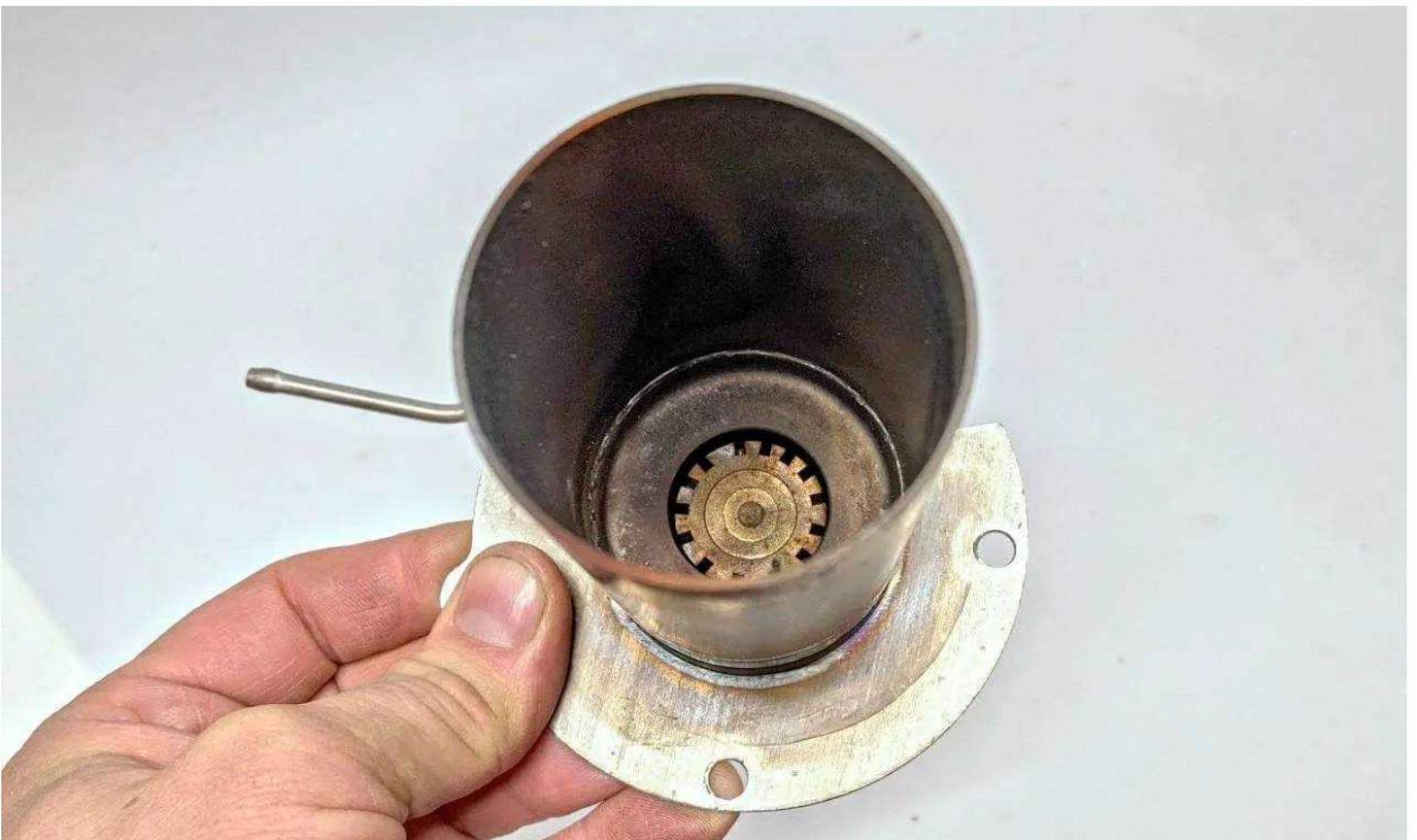
Der Brenner von innen, sichtbar ist die unten liegende Wirbelkammer. Dort verdampft und verbrennt der Diesel.
