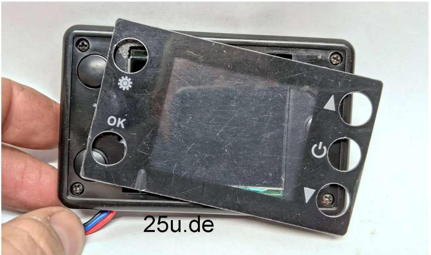
Falls jemand das Bedienteil auseinanderbauen will: die vier Schrauben um das Gehäuse zu öffnen befinden sich hinter der geklebten Abdeckung.
