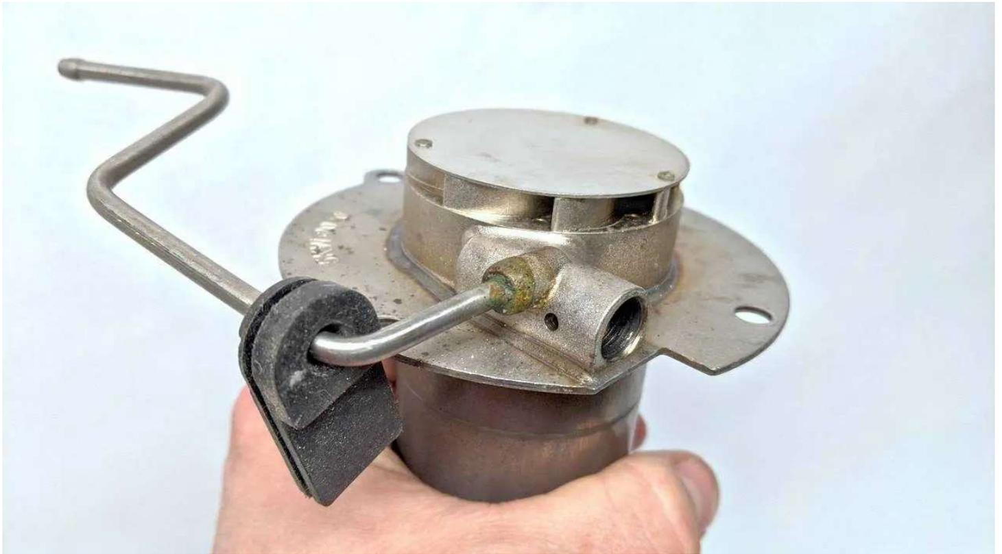
Die Fassung der Glühkerze hat eine Bohrung, direkt dort wo die Dieselleitung in den Brenner führt. Ich hab noch nicht rausgefunden, wozu die da ist, aber wenn die Heizung falsch (z.B. hochkant) montiert wird läuft dort der Diesel aus und sie funktioniert nicht.
