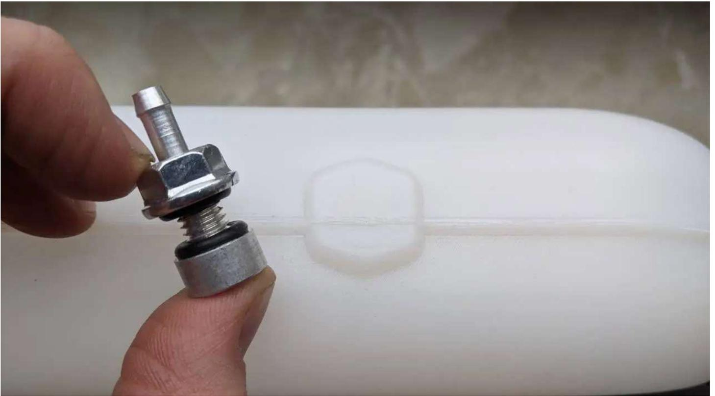
Bei den aktuell verkauften Anlagen scheint nur ein kleiner Tankentnehmer beizuliegen. Der Einbau ist etwas knifflig. Auf einen Draht auffädeln, von innen gegenpressen und von aussen festziehen funktioniert am besten.
