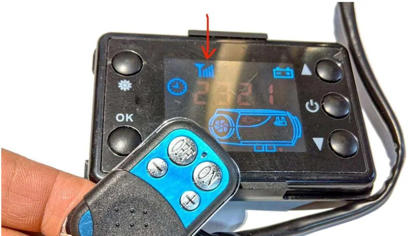
Die 2020 verkaufte Variante ist mit Funkteil, das erkennt man an dem „Antenne mit Funkbalken“ Symbol oben links. Anlernen lässt sich nur die abgebildete Fernbedienung, andere werden scheinbar nicht erkannt. Die Funk Fernbedienung wird auch einzeln verkauft, als Ersatzteil oder zum Nachrüsten. Sie kostet direkt aus China nur ca 5 bis 6 Euro.
