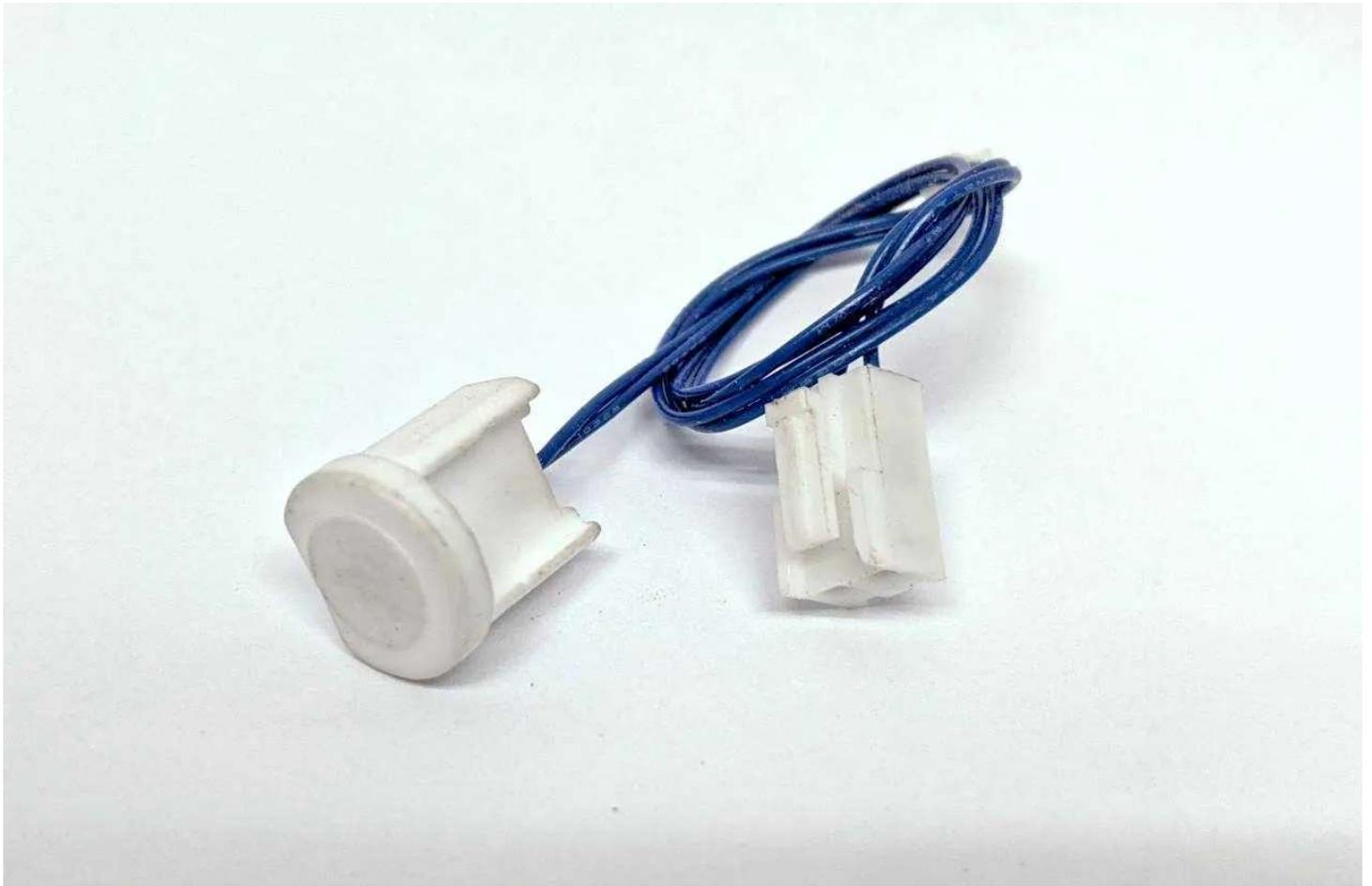
Der Thermosensor. Bei Zimmertemperatur hat er ca 75K Ohm, erhitzt sind es ca 25K Ohm.
