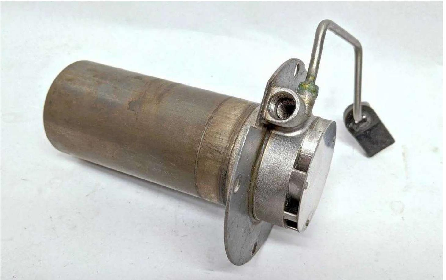
Der Brenner. Die Glühkerze wird in das Gewinde mit dem Drahtgeflecht geschraubt
