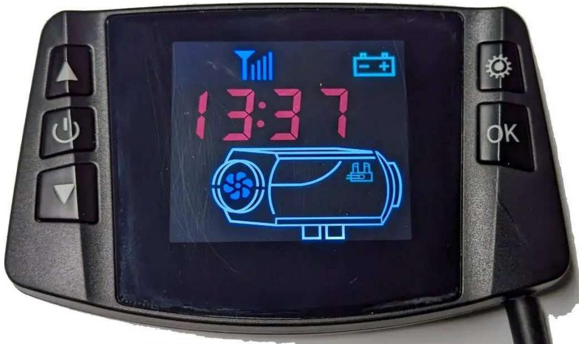
Ein weiteres Steuergerät mit Uhr, aus einer Vevor 5KW gelabelten Dieselheizung. Intern ist die Platine mit KT20796 gekennzeichnet. Die Tasten sind anders angeordnet, aber die Bedienung ist identisch. Das Bedienteil ist kompatibel (austauschbar) mit den hier gezeigten Displays und hat den üblichen, dreieckigen Stecker.
