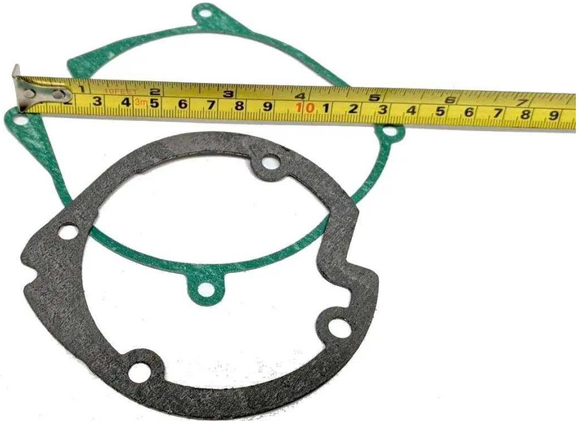
Dichtsatz. Kostenpunkt ca 3 Euro inkl Versand aus China. Der Dichtsatz ist baugleich mit dem Eberspächer Kit 252113010003 / 252113060001 für Airtronic D4/D4S. Die innere Dichtung muss auf jeden Fall ersetzt werden, wenn die Heizung längere Zeit gelaufen ist und gereinigt werden muss. Die 5KW / 8KW Heizungen haben stets 4 Schrauben. Die 2KW Heizung ist kleiner und hat innen nur 3 Schrauben. Danke an Florian für die Korrektur !
