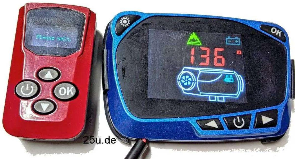
Das blaue Bedienteil hat im Gegensatz zum schwarzen ein Barometer eingebaut und verbindet sich mit der LCD-Fernbedienung.
