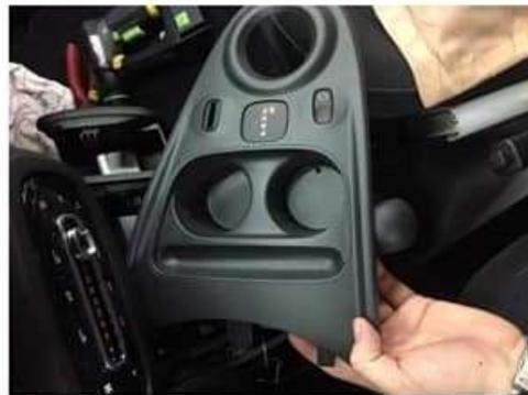
3. Maurerschnur mit Kabelbinder möglichst weit außen am Entriegelungshebel befestigen und mit Sekundenkleber gegen Abrutschen sichern. Danach durch den Becherhalter nach oben führen.
