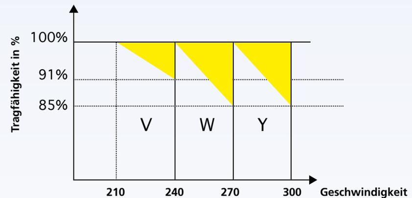
Für dazwischen liegende Geschwindigkeiten nimmt die Reifentragfähigkeit linear ab!
