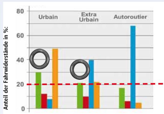
Im Durchschnitt wird 1 von 5 Tankfüllungen (20%) für die Überwindung des Rollwiderstands der Reifen benötigt.
