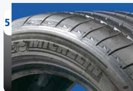
Manchmal ist ein umlaufender Flankenabrieb zu erkennen, der durch längeren Kontakt dieses Reifenteils mit dem Boden entsteht.
