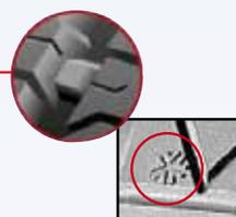
**Verschleißanzeiger 4 mm:** Verschleißanzeiger, die erscheint, sobald ein Restprofil von 4 mm erreicht ist. Bei MICHELIN Winterreifen zeigt ein Schneeflockensymbol auf der Reifenflanke die Lage der Verschleißanzeiger für Winterreifen an.
