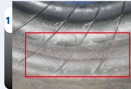
Ein Reifen mit Verfärbungen darf auf keinen Fall repariert und wieder in Verkehr gebracht werden.
