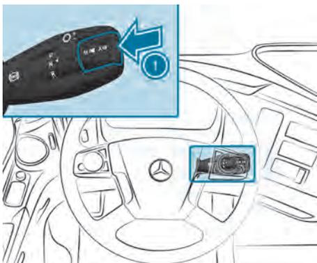
Nach dem Fahrzeugstart ist immer ein Automatik-Fahrprogramm eingeschaltet. Bei Fahrzeugen mit dem Schaltprogramm **power** ist dies die Standard-Automatik **A**. Bei Fahrzeugen mit dem Schaltprogramm **fire-sv** ist dies immer das Fahrprogramm **A fire-sv**.
