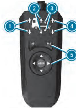
Bedieneinheit (Beispiel bei vollluftgefederten Fahrzeugen)
